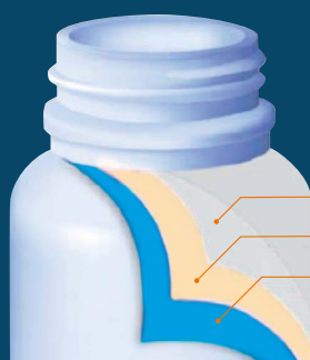
Barrierschicht Haftvermittler HDPE Außenwand
