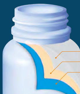
Barrierschicht Haftvermittler HDPE Außenwand
