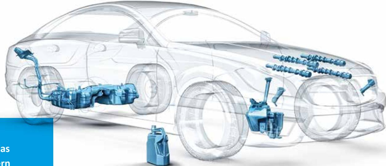
**Hohlkörper, geblasen aus Kunststoff, können in die unterschiedlichsten Formen gegeben werden. Die Idee der Kunststoffblasformtechnik ließ Reinold Hagen – Firmengründer von Kautex – 1950 patentieren. 1949 hatte er bereits die erste Kunststoffblasmaschine auf den Europäischen Markt gebracht.**
